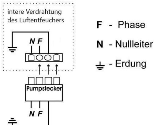
Wird eine Kondensatpumpe verwendet, muss diese an die Buchse unter der Wasserwanne des Luftentfeuchers angeschlossen werden. Nur dann ist es möglich sie wieder einzuschalten.
