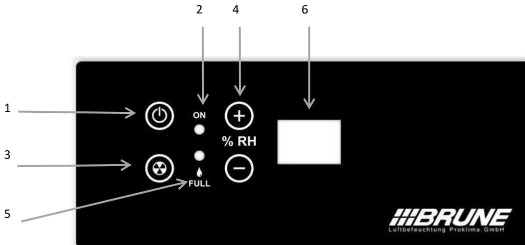
1 – EIN/AUS-Taste (Standby-Taste) zum Ein- und Ausschalten des Entfeuchters
